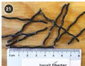
Figures 19 à 24 - Essais de bétons à l'aide de divers bâtonnets de basalte.
