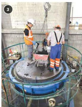
Figures 1 à 3 - Filets de renforcement en basalte pour la production des tubes en béton (Usine d'éléments de béton Creabeton).
